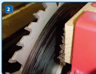
Fig. 1 Esempio di misurazione della temperatura durante la prova di sfregamento di una lama senza rivestimento.
